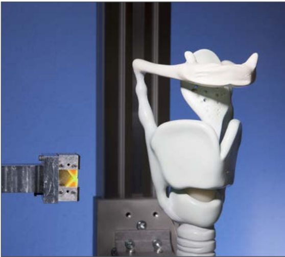
Abb. 6: Strömungsinduziertes selbstschwingendes Stimmlippenmodell (ohne Berücksichtigung von Taschenfalten und Vokaltrakt) in Beziehung zu einem Modell des Kehlkopfes
